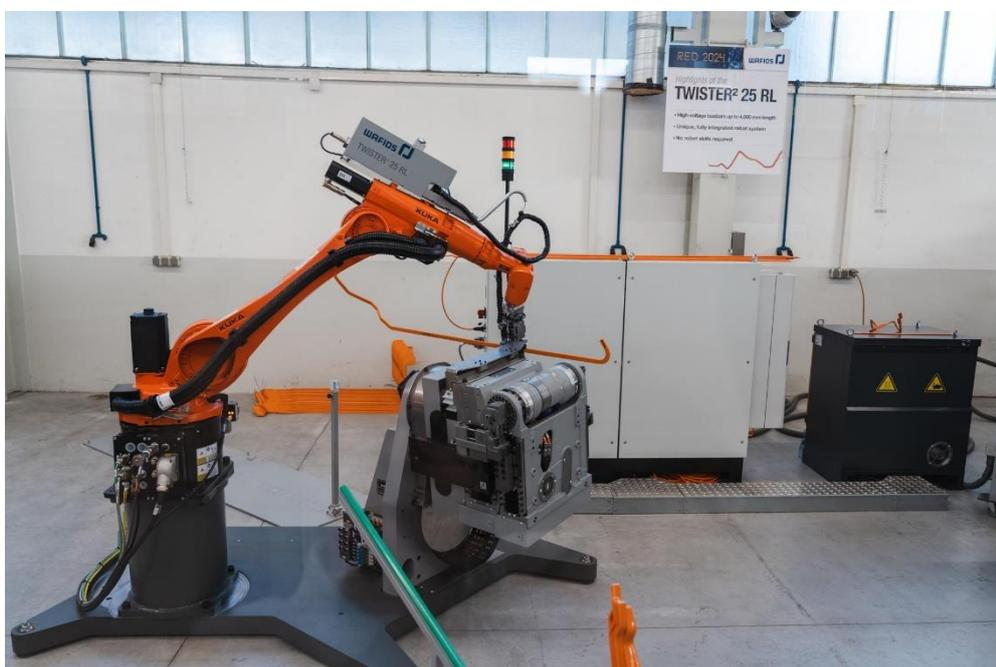
Abb. 4. Der TWISTER² 25 RL erweitert das Programm der Stromschienenbiegemaschinen. Bild: WAFIOS
