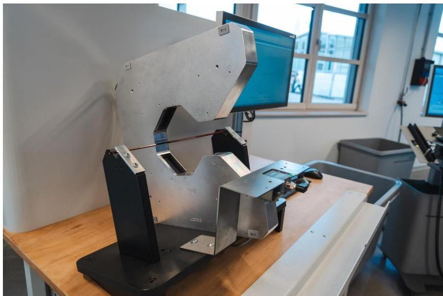
Abb. 5. An der FMU 40 E präsentierte WAFIOS unter anderem das halbautomatisierte Richten mithilfe einer Messzelle. Bild: WAFIOS
